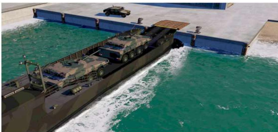
この装備の特色は、日本向けに岸壁からも戦闘車を揚陸できることである。さらにカイマン 90 は 90t 輸送するのに、喫水は最大 1.5m であり、22~40 ノットのスピードで MCV なら 3 両（新水陸両用車なら 2 両積載し、大隅型揚陸艦に 4 隻収納可）運搬できる。航続距離は 900km 以上で、鹿児島から宮古島まで運搬できる能力がある。
