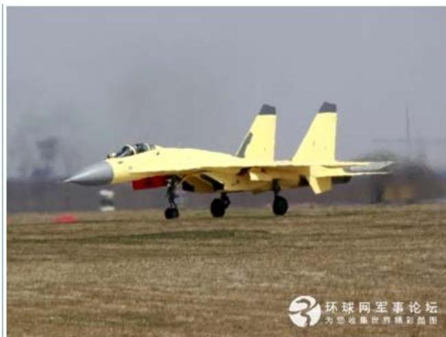
中国のネット上に SU-33 型艦載機のクローン型 J-15 の写真が掲載された。写真を見ると、カナード翼、着艦フックを装備し、T-10K 型艦載機試験機 03 及び 07 号機の外観と完全に一致している。また写真上からは、エンジンは、ロシア製の AL-31F 型エンジンであり、HUD (ヘッドアップ・ディスプレイ) は、J-11B 型戦闘機と同じ広角型であるようだ。これは、KDR の予想が正しかったことを示している。すなわち J-15、J-11B 及び J-11BS のアビオニクスは、多くの共通点があるということだ。写真の J-15 は、海軍用の塗装であり、以前の試験飛行時の塗装は無塗装であった。写真は、瀋陽の工場で撮影されたものであり、“工場内試験飛行が既に終了したのかどうか？” 観察する必要がある。
