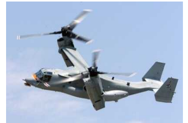
ティルト・ローター機 (写真はV-22 オスプレイ)
