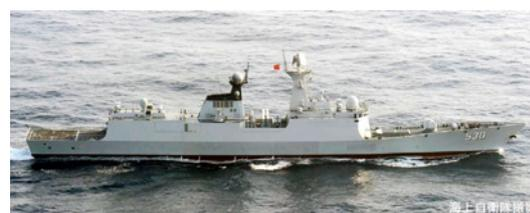
ジャンカイII級フリゲート（写真：統合幕僚監部）
